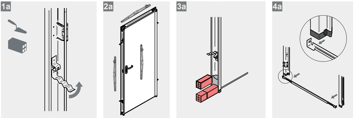
Instalación con tornillos / Screw installation / Fixation par vissage / Instalação com parafusos
