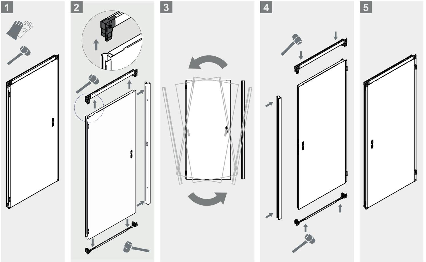
Instalación con garras / Anchor installation / Fixation par pattes de scellement / Instalação com garras
